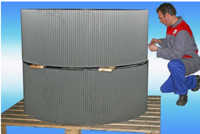
HTD Tandriempoele t.b.v. aandrijving voederpers
